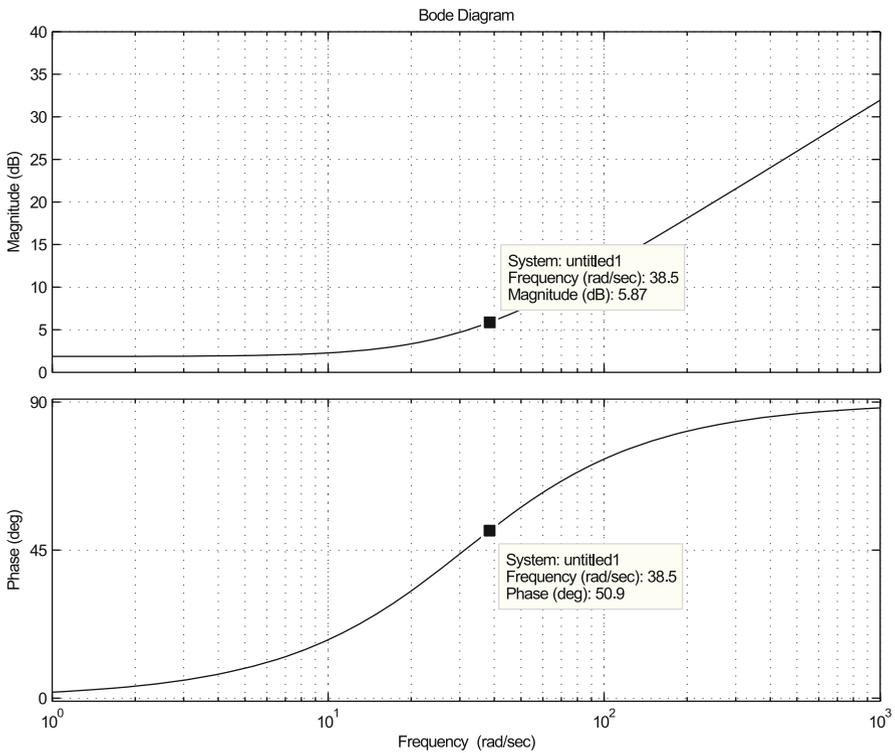
Fig. 6.95 Bode diagrams of  $k(s + b)$ ,  $b = 31.2463$ ,  $k = 0.0396$
